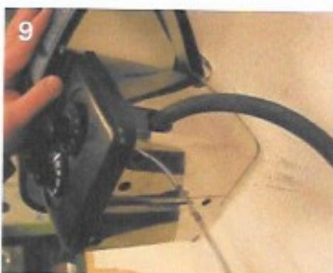
Remettez en place le corps en plastique. Serrez la vis.
